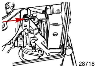
3. Нанести антикоррозийную смазку Quicksilver или Mercury Precision или 2-4-C с тефлоном на следующие участки.
