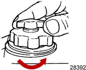
3. Откройте клапан отсеки топлива.
