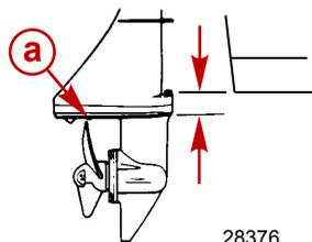
**a** - Противовентиляционная пластина
