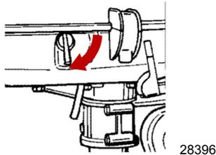
4. Подсоедините шнур к выключателю останова двигателя. См. раздел **Общая информация - Выключатель со шнуром дистанционной остановки двигателя.**
